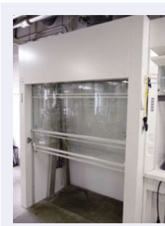
左の写真は、いわき事業所内の研究所に導入されたウォークインドラフトです。導入により有害な化学物質へのばく露が低減されました。
