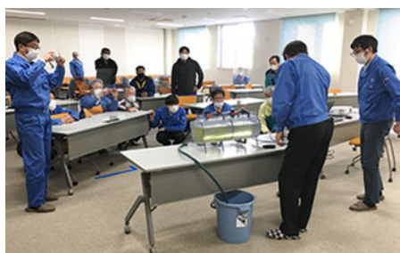
2槽タンク模型による同時卸実証実験
