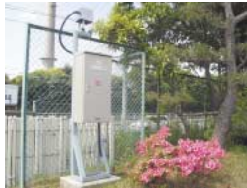
臭気センサー(臭気自動モニタリング・採取システム) 敷地境界に設置されたセンサーが一定レベル以上の臭気を検知すると、制御室に警報を発すると共に空気を自動的に採取します。
