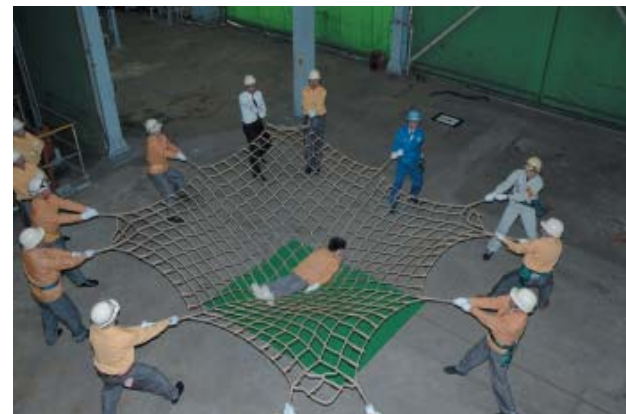
8メートルの高さからマネキンを落下させ衝撃を感じ取る
