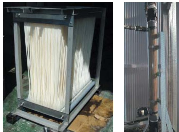
膜モジュール 浸漬型(左)と加圧カートリッジ型(右)
