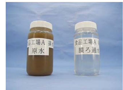
左：膜分離槽原水 右：透過水
