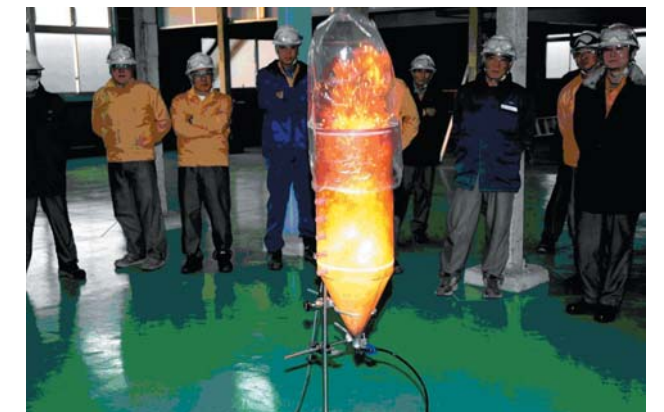
一般家庭で用いられている小麦粉による粉塵爆発実験
